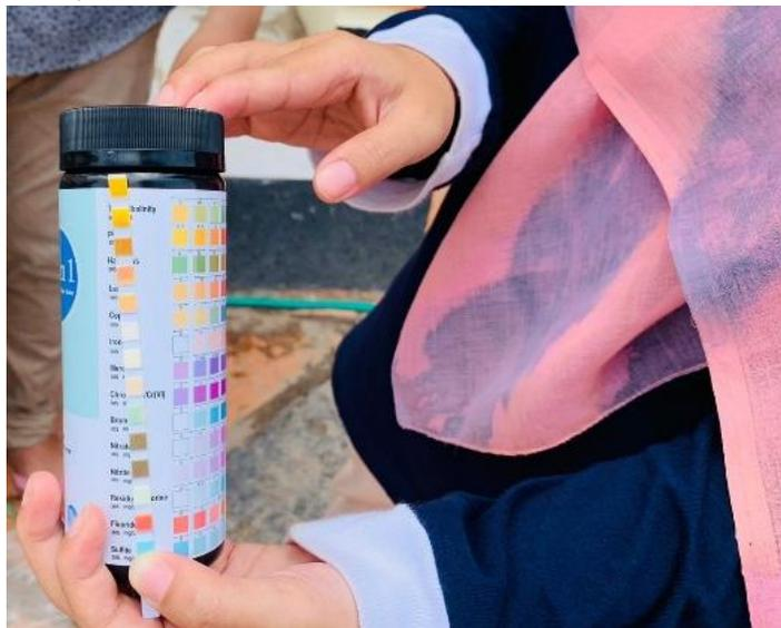
**Gambar 3.** Hasil membandingkan *strip test* yang telah dicelupkan kedalam air sumur dengan indicator.
