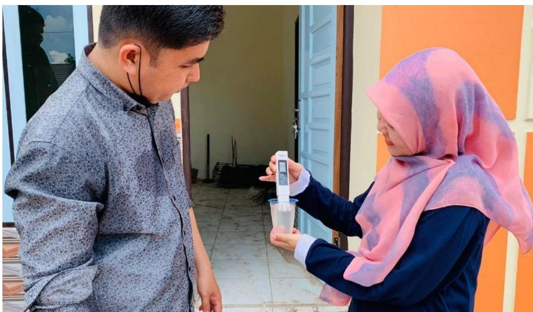
Gambar 2. pengujian air sumur dengan *pH* meter
